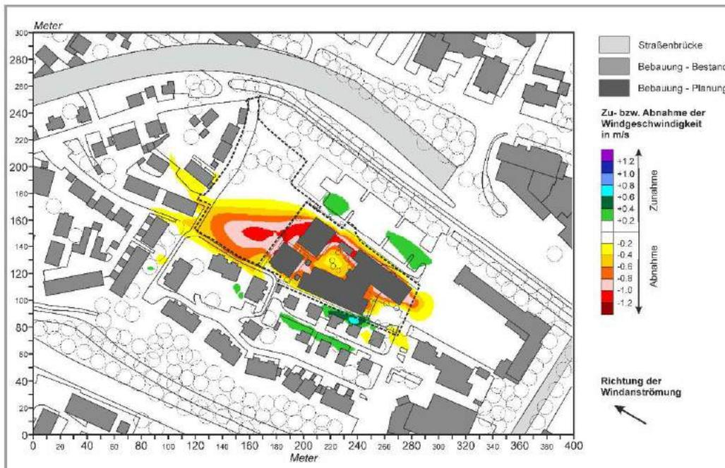
**Abb. 14.3:** Vorher-Nachher-Vergleich zwischen Planungsnullfall und Ist-Zustand (Ergebnisse mikroskaliger Strömungssimulationen). Windgeschwindigkeiten und Windrichtungen 1,5 m ü.G. bei einer Windanströmung aus Ost-südosten (120°) mit 2,0 m/s in einer Höhe von 10 m ü.G.
