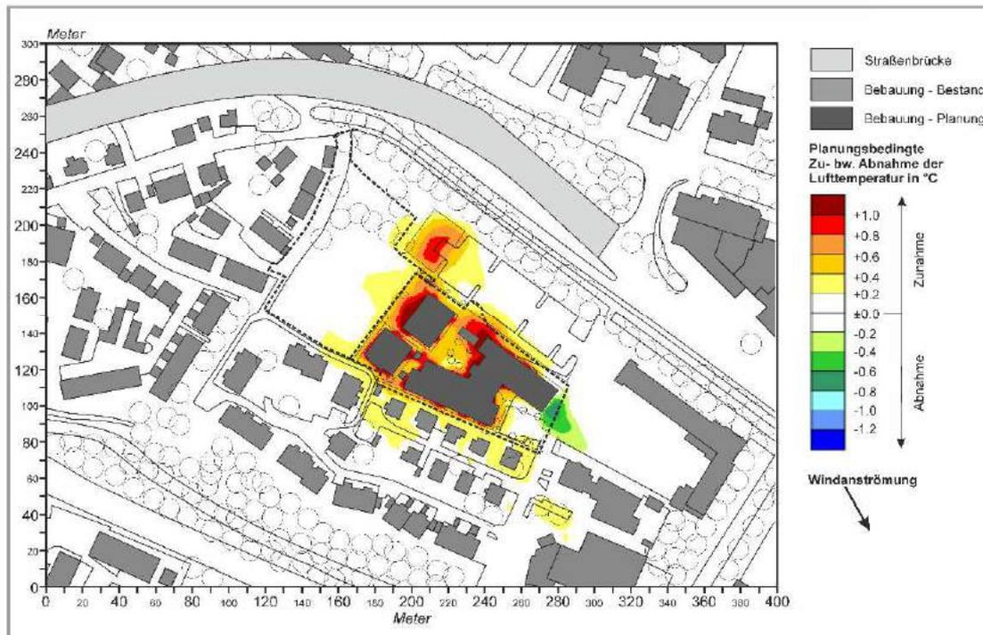
**Abb. 16.3:** Vorher-Nachher-Vergleich zwischen Planungsnullfall und Ist-Zustand (Ergebnisse mikroskaliger Lufttemperatursimulationen). Lufttemperatur 1.5 m ü.G. bei einer Windanströmung aus Nordnordwesten (330°) mit 2.0 m/s in einer Höhe von 10 m ü.G.
