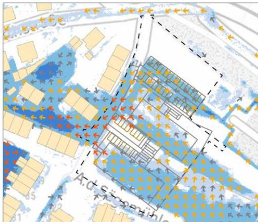
Abbildung 9: Starkregengefahr im Ist-Zustand, Überflutungstiefen und Fließgeschwindigkeiten bei einem seltenen Starkregenereignis (Quelle: Geomer, 2024)
