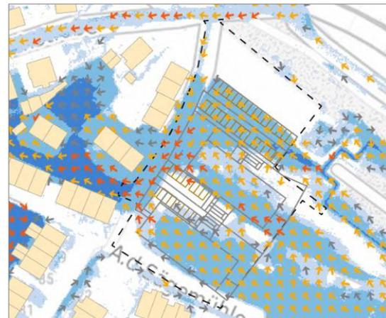
Abbildung 10: Starkregengefahr im Ist-Zustand, Überflutungstiefen und Fließgeschwindigkeiten bei einem außergewöhnlichen Starkregenereignis (Quelle: Geomer, 2024)
