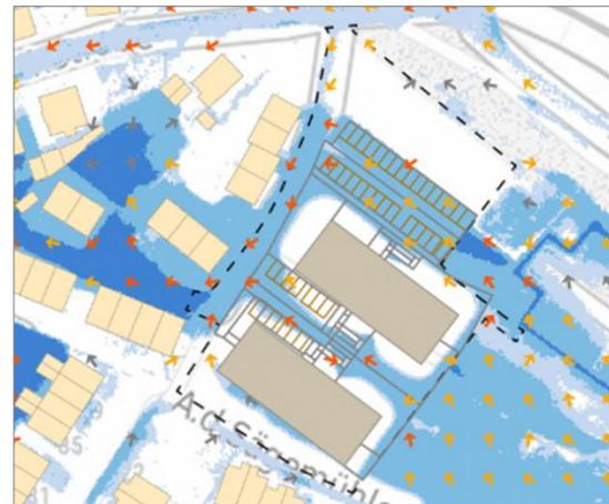
Abbildung 12: Starkregengefahr im Plan-Zustand, Überflutungstiefen und Fließgeschwindigkeiten bei einem außergewöhnlichen Starkregenereignis (Quelle: Geomer, 2024)
